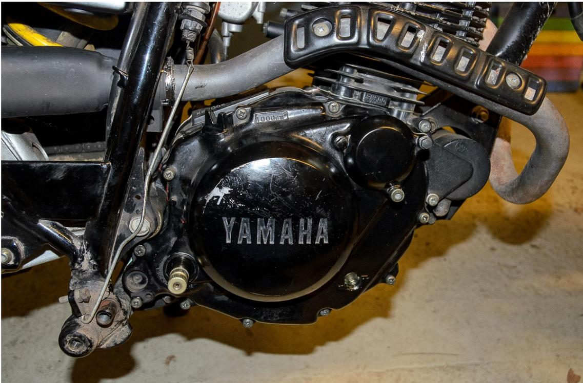
(Tipp: Die Schrauben sind butterweich und das Gewinde im Motorblock sowieso – wenn der Drehmomentschlüssel bei einer Schraube nicht auslösen will, einfach so lassen – andernfalls ruiniert man entweder Schraube oder Gewinde im Block)
