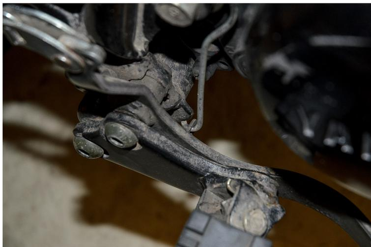
Der Bremshebel wird nun nach außen von seiner Lagerstelle abgezogen und muss dann noch vorsichtig und mit etwas Verdrehen aus dem Draht zum Bremslichtschalter ausgehängt werden. Den Draht danach etwas zur Seite legen, damit er aus dem Weg ist.
