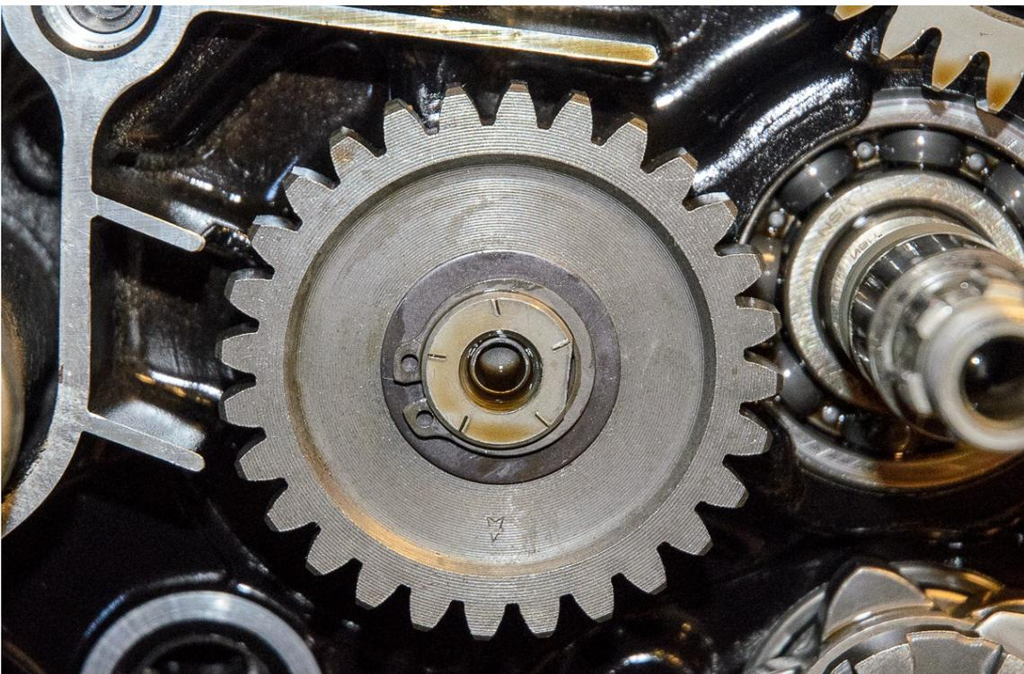
Das Zwischenrad muss sich jetzt leicht auf der Welle drehen lassen, ohne irgendwo zu schleifen. Ohne die dünne Anlaufscheibe hinter dem Zahnrad hätten die Zähne z.B. Kontakt zum
