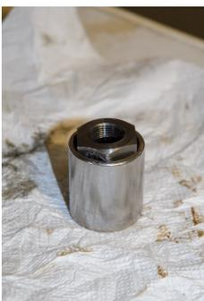
Die Mutter, die sich hinterher kaum aus der Nuss bequemen will, muss von hinten mit einem stumpfen Schraubendreher o.ä. herausgeschlagen werden.
