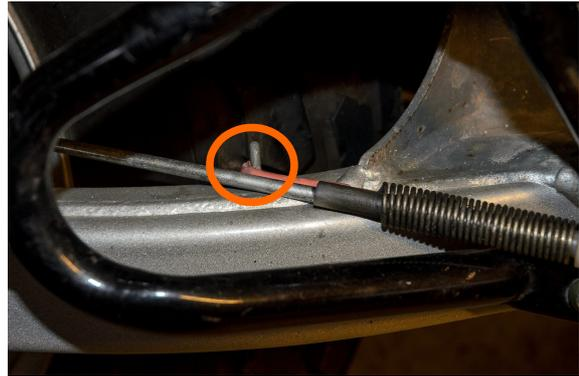
Den kleinen Zylinder am Gestänge verliersicher verstauen (ich schraube ihn immer mit der Flügelmutter am Gestänge fest).
